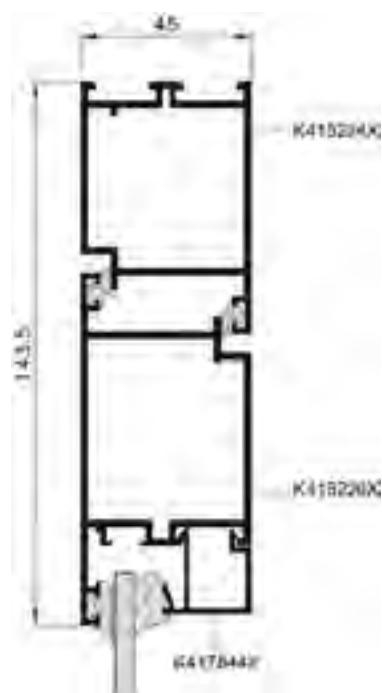
Dwarsdoorsnede deur onder zonder drempel
